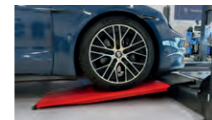
Lange ramper til lave køretøjer (valgfrit)
