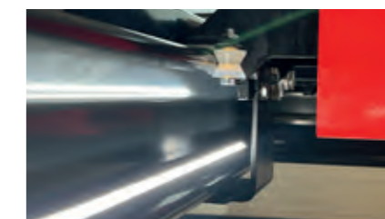
Ophæng for saksedonkraft på inder-side af kørebane profil
