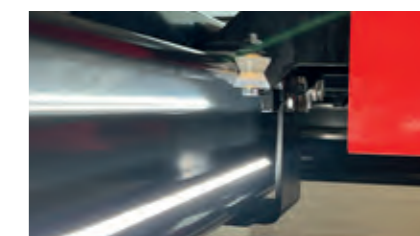
Ophæng for saksedonkraft på inder-side af kørebaneprofil
