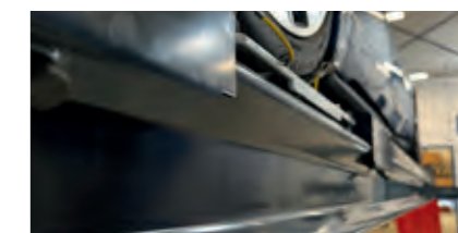
Bukket profil for høj kørebanestabilitet
