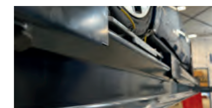
Bukket profil for høj kørebane stabilitet
